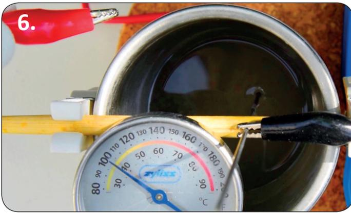
Improvisierte Halterung für die Elektrode: Ein Loch ins Esstäbchen bohren, und die Wolfram-Schweißelektrode hindurchstecken. Die beiden Wäscheklammern halten alles aufrecht, denn die Elektrode darf den Becherrand niemals berühren!
