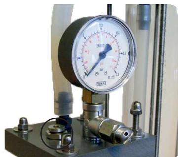
Hier nochmal der Vorratsbehälter mit Manometer und (optionalem) Überdruckventil. Der Verschluss-Stopfen (schwarzer Kreis) dient zum leichteren Nachfüllen mit destilliertem Wasser.
