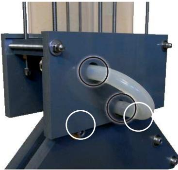
Nun die Halteplatten mit den Behältern wie abgebildet auf die DryCell aufstecken. Falls es an den Schlauchtüllen der 48V-DryCell zu eng wird, einfach die obere Halterung ein wenig aufschrauben. Die obere Halterung soll auf den Gewindeschrauben der DryCell aufliegen (weiße Kreise). Nun die Endmuttern der Gewindestangen festziehen.
