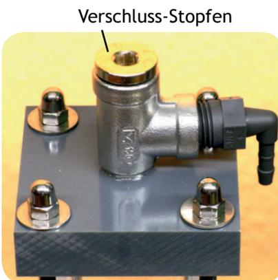
Wenn kein Manometer vorhanden: Verschluss-Stopfen oben ins T-Stück einschrauben (Dichtring ist im Stopfen eingebaut).
